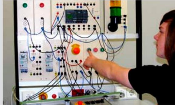
Eine Schaltung für eine vollautomatische Anlagensteuerung wird probeweise im Labor aufgebaut.
