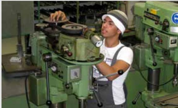
Der Keilriemen der Bohrmaschine wird gewechselt.
