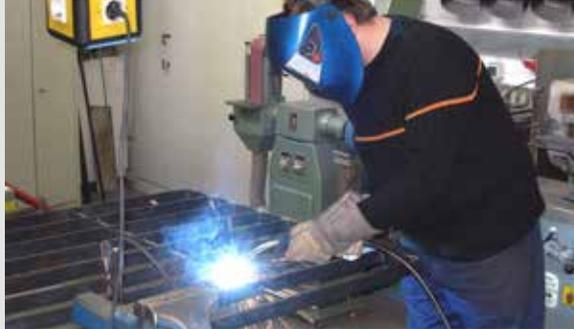
Beim Schweißen werden die Einzelteile gefügt.
