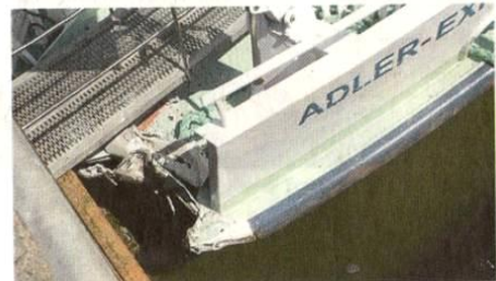
Der Rumpf der Fähre wurde beim Aufprall einen Meter eingedrückt.
