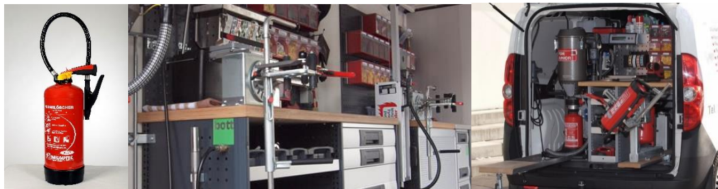
Arbeitsplätze zur Instandhaltung von Feuerlöschgeräten
