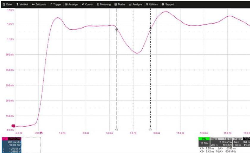
Abbildung 8: TDR Messung einer Fehlstelle
